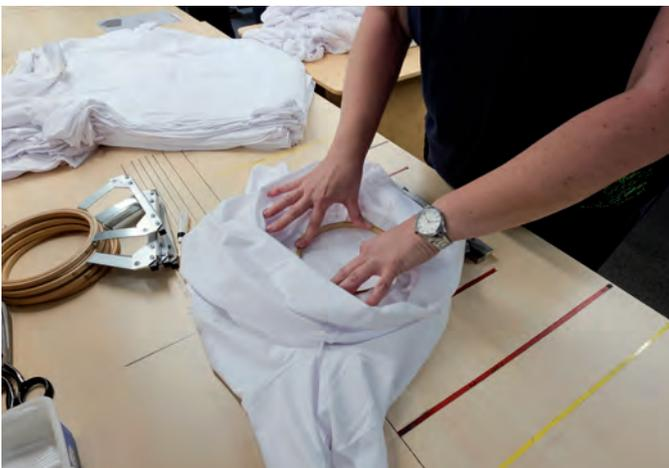
Zu bestickende Fläche wird mit Spannrahmen vorbereitet
